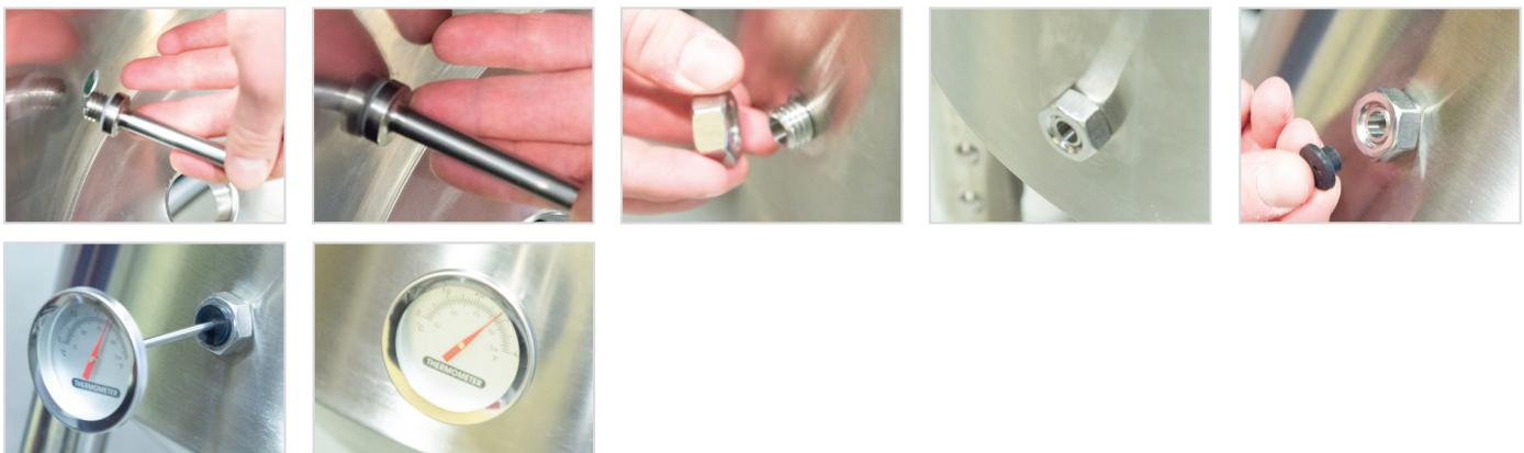
An der Unterseite des Gärbehälters befinden sich 2 Bohrungen. Ursprünglich ist die obere Bohrung für die Montage des Abfüllventils vorgesehen. Die Dichtung in die vorgesehene Aussparung legen und den Hahn daraufsetzen. Das Tri-Clamp-Anschlussstück herumlegen und festziehen. Tipp: Den Dreharm wie abgebildet in den Ventileingang stecken, wobei die Ausrichtung des Abfüllarms durch Drehen des Kugelhahns während der Gärung angepasst werden kann.
