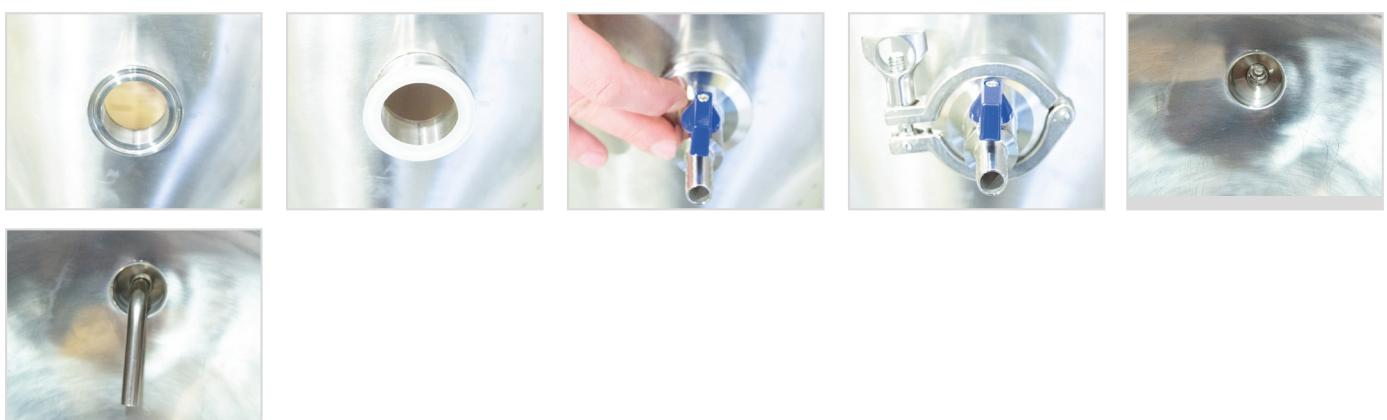
Het onderste gat in het gistingsvat is bedoeld voor het bevestigen van de grote vlinderklepkraan. Je kan ervoor kiezen om de bocht eerst te monteren. Ga op dezelfde manier te werk als bij de bovenste kraan.
