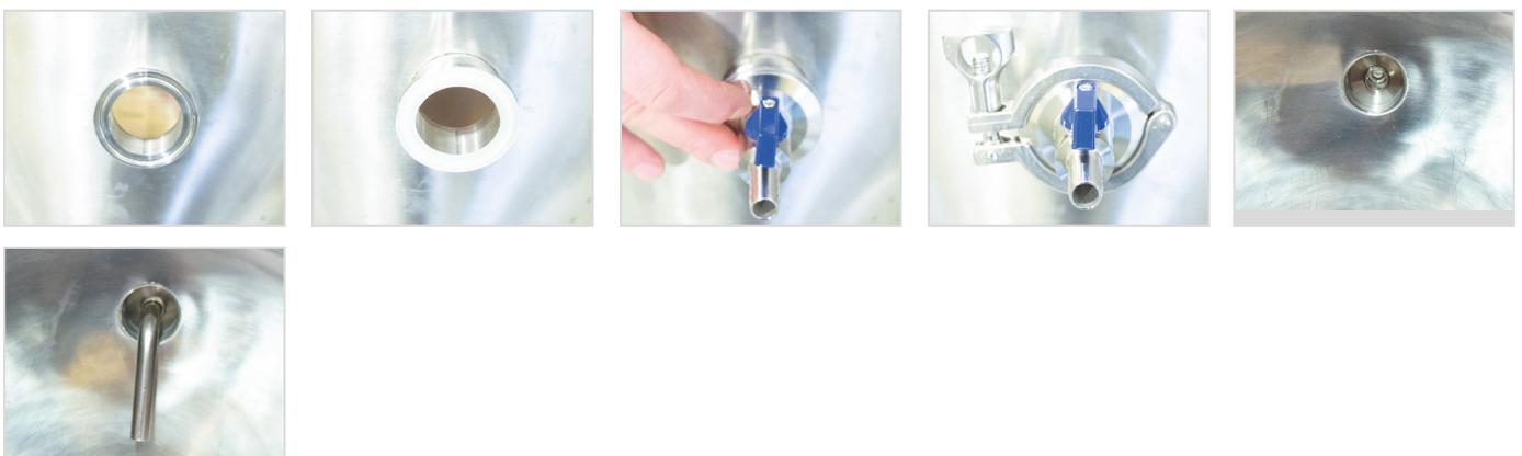
Die untere Bohrung im Gärbehälter dient zur Montage des großen Scheibenventils. Es ist möglich, das Bogenrohr zuerst zu montieren. Wie beim oberen Hahn vorgehen.
