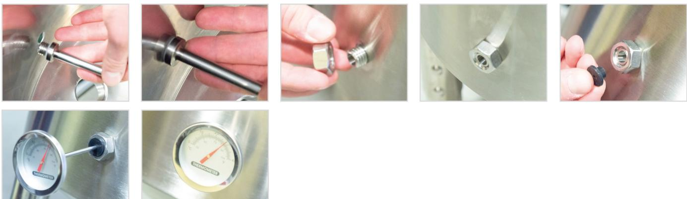
Le fond de la cuve de fermentation comporte 2 trous. À l'origine, le trou supérieur est destiné au montage de la vanne de mise en bouteille. Maintenez le joint sur le renflement qui se présente et placez le robinet contre celui-ci. Enroulez le raccord tri-clamp autour et serrez. Conseil : insérez le bec pivotant dans l'entrée du robinet, comme indiqué, l'orientation du bec de soutirage pouvant être ajustée en faisant pivoter le robinet à boule pendant la fermentation.
