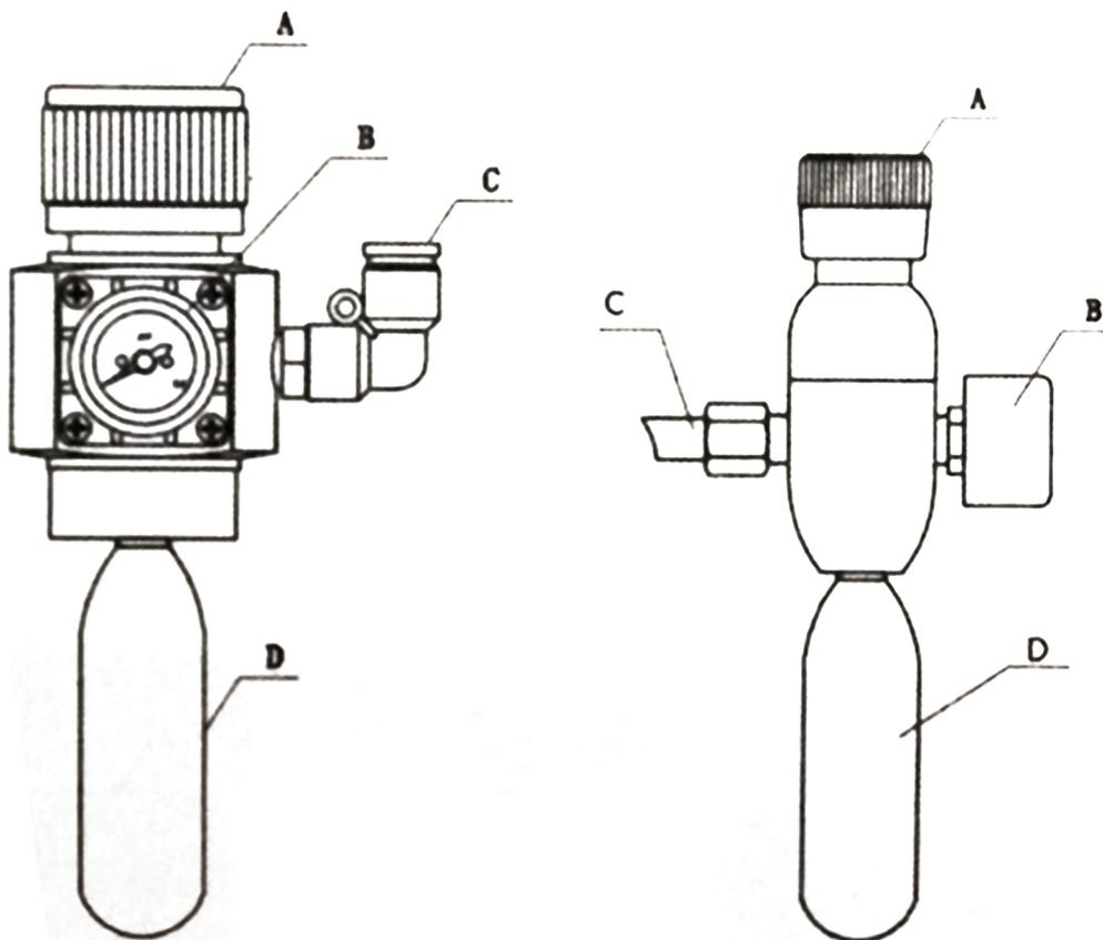
A : Régulateur de pression CO2 (vis de réglage du régulateur)
